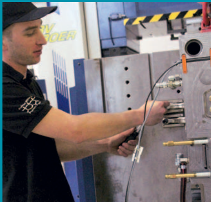
Bei senkrecht gestelltem Tisch kann das Werkzeug per Kran positioniert und fixiert werden.
