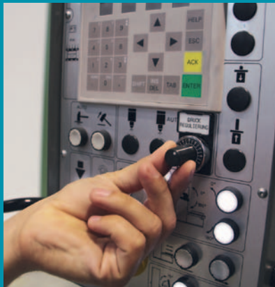
Die Regulierung für den Pressendruck und die Werkzeughydraulik ist eine Sonderlösung.
