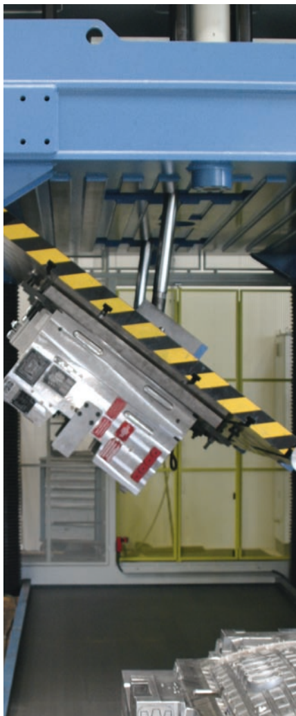
Der Stempel des Werkzeugs kann um 180° geschwenkt und dann in ergonomischer Arbeitsposition vor der Presse abgelegt werden.
